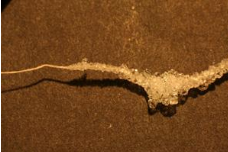
Bild 11: Nach einigen Tagen haben sich am Faden Kristalle gebildet.
